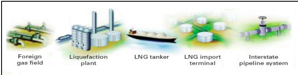
Figure 1: LNG Supply Chain
